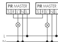
Subdivision d'une grande zone de détection en différentes zones d'éclairage avec mesure individuelle de la luminosité.
