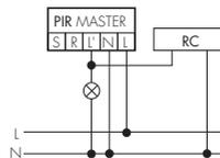
Lors du branchement d'inductances parallèles au réseau (lampes lumineuses, contacteurs, etc.), un circuit RC peut être nécessaire.
