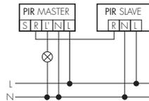
Agrandissement de la zone de détection avec un ou plusieurs appareils Slave. Attention: L'appareil Master doit toujours être monté à l'endroit où la quantité de lumière est la plus faible.
