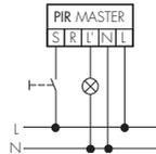
La lumière peut être allumée ou éteinte manuellement en fonction des besoins grâce à la commande à pousoir.
